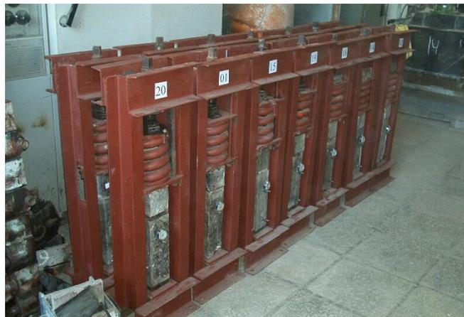
**Рис. 2.** Лабораторные установки длительного нагружения бетона
