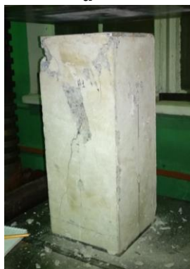
Рисунок 6. Испытание образцов-призм на сжатие: a – процесс испытания; b – общий вид образцов после испытания
