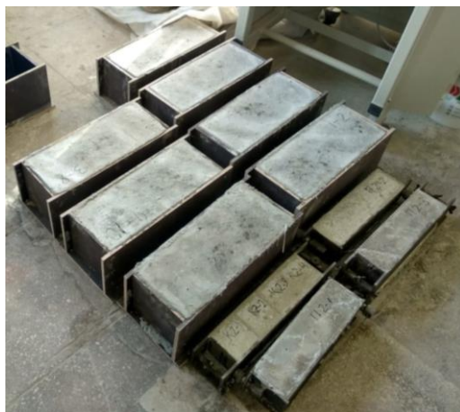
Рисунок 5. Изготовление образцов-призм в лаборатории НИИЖБ Figure 5. Production of prism samples in the laboratory of NIIZHB
