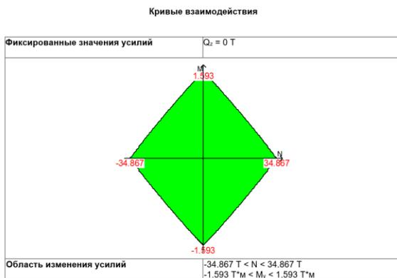
**Рисунок 9.** Кривые взаимодействия сварного соединения
