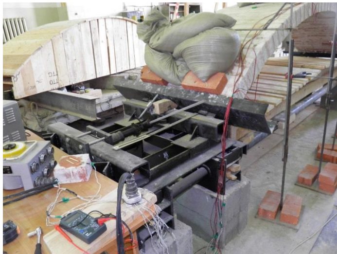
Рис. 9. Установка для создания горизонтальной подвижки опоры Figure 9. Installation for creating a horizontal movement of the support
