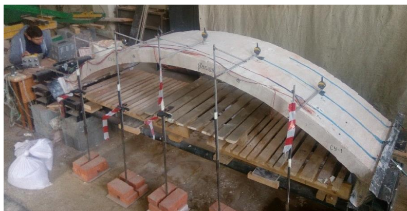
Рис. 10. Усиленный свод серии СУ-2 углеволоконными жгутами. Figure 10. Reinforced vault of the SU-2 series with carbon fiber bundles.
