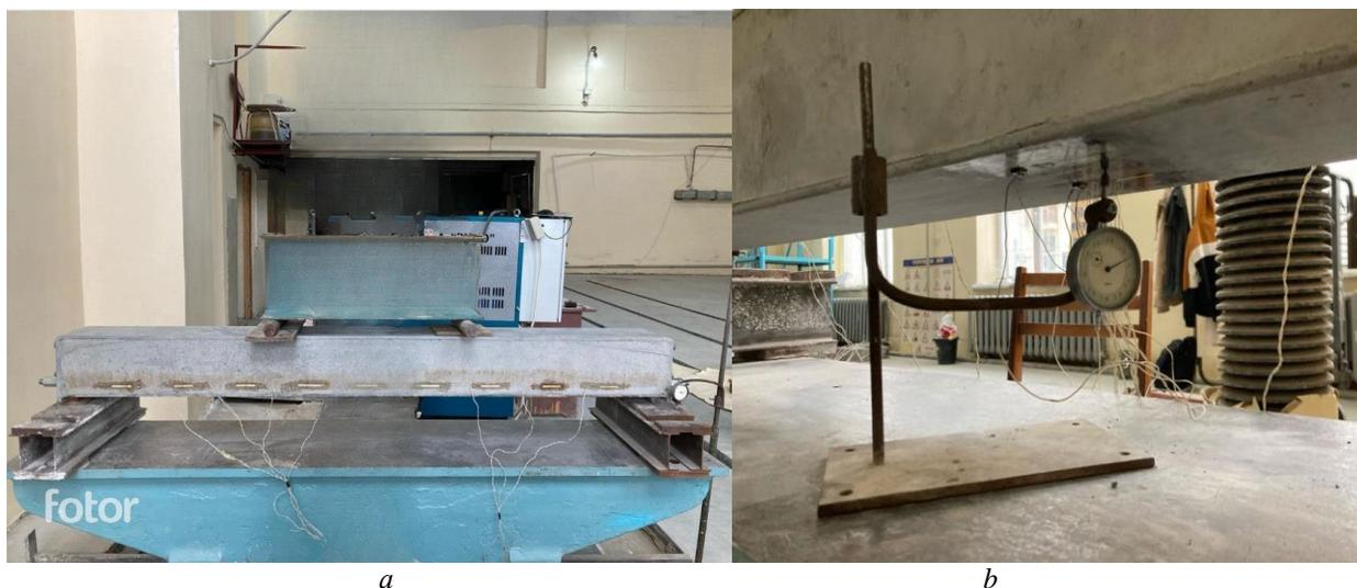
Рис. 2. Сталебетонная балка в установке: *a* — общий вид; *b* — измерение прогиба
