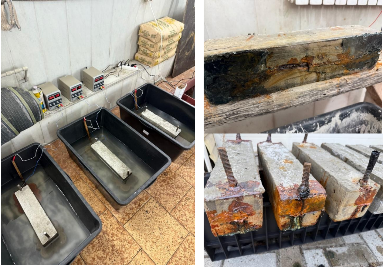
Рис. 4. Процесс электрохимического метода стимуляции коррозии в элементах Fig. 4. The process of the electrochemical method of stimulating corrosion in the elements
