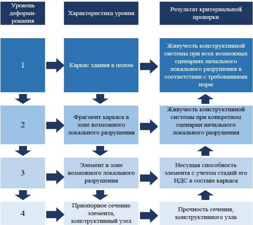
Рис. 1. Связь уровней деформирования и системы критериев Fig. 1. Relationship of deformation levels to the system of criteria
