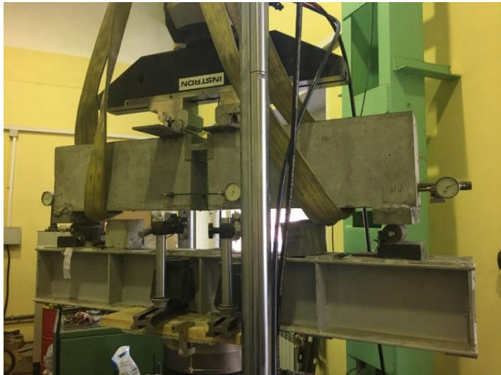
Рис. 4. Общий вид испытания балок Fig. 4. General view of beam testing
