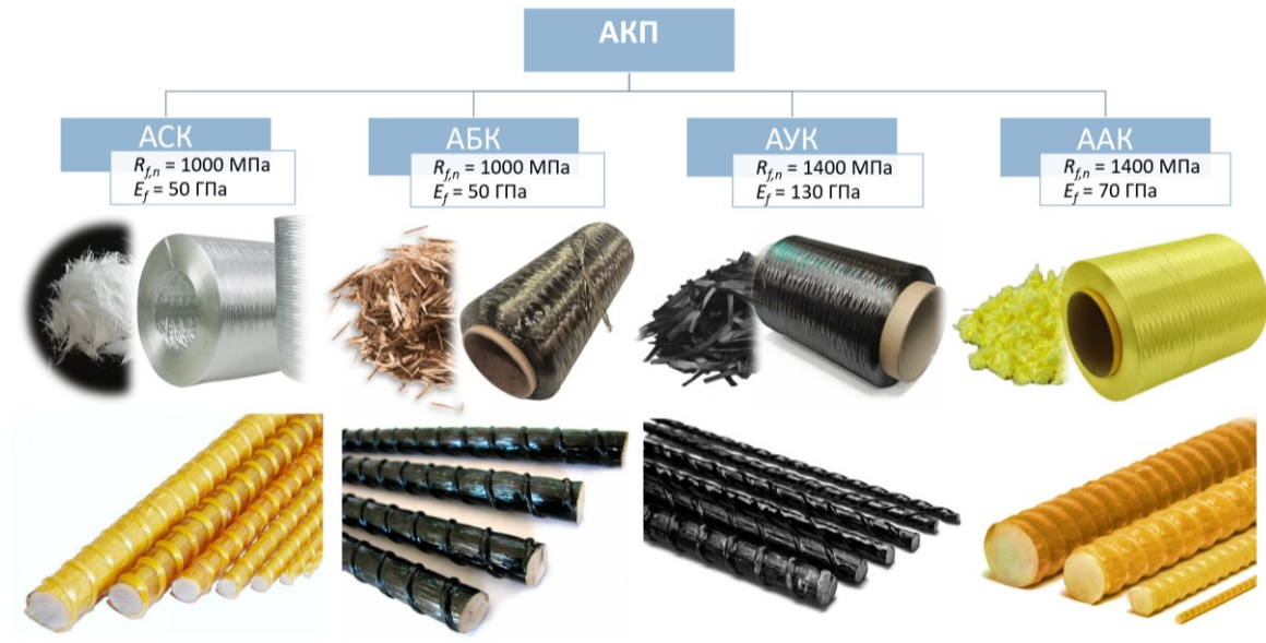
Рис. 1. Виды арматуры композитной полимерной (АКП) Fig. 1. Types of fiber-reinforced polymer bars (FRP bars)
