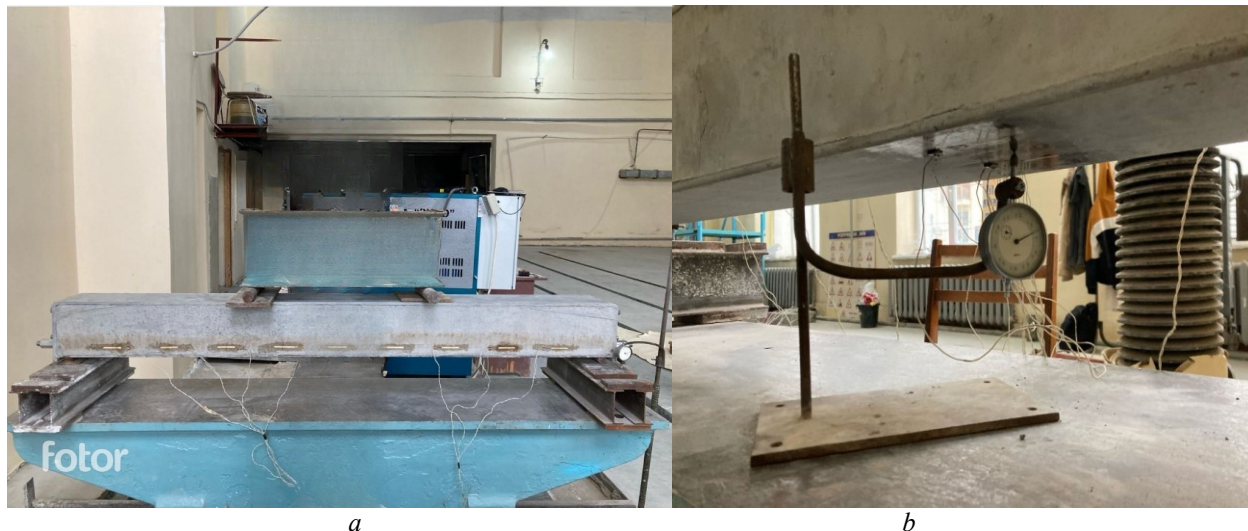
Рис. 2. Сталебетонная балка в установке: a — общий вид; b — измерение прогиба Fig. 2. Steel-concrete beam in installation: a — General view; b — Deflection measurement
