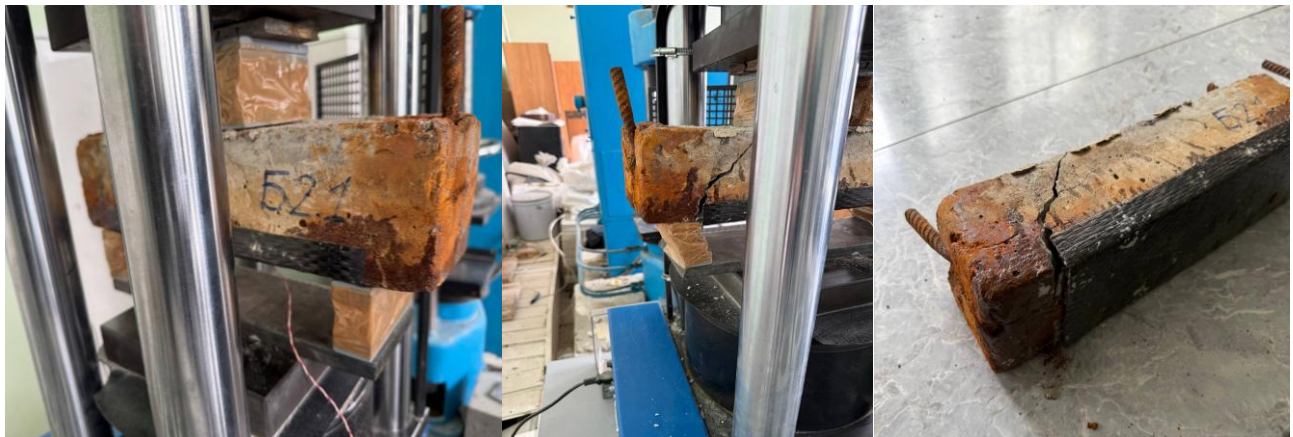
Рис. 6. Испытание и разрушение образцов Б.2 Fig. 6. Testing and destruction of samples B.2
